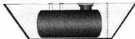
Ilustración 6. Ejemplo Pozo de Observación en fosa no impermeable
